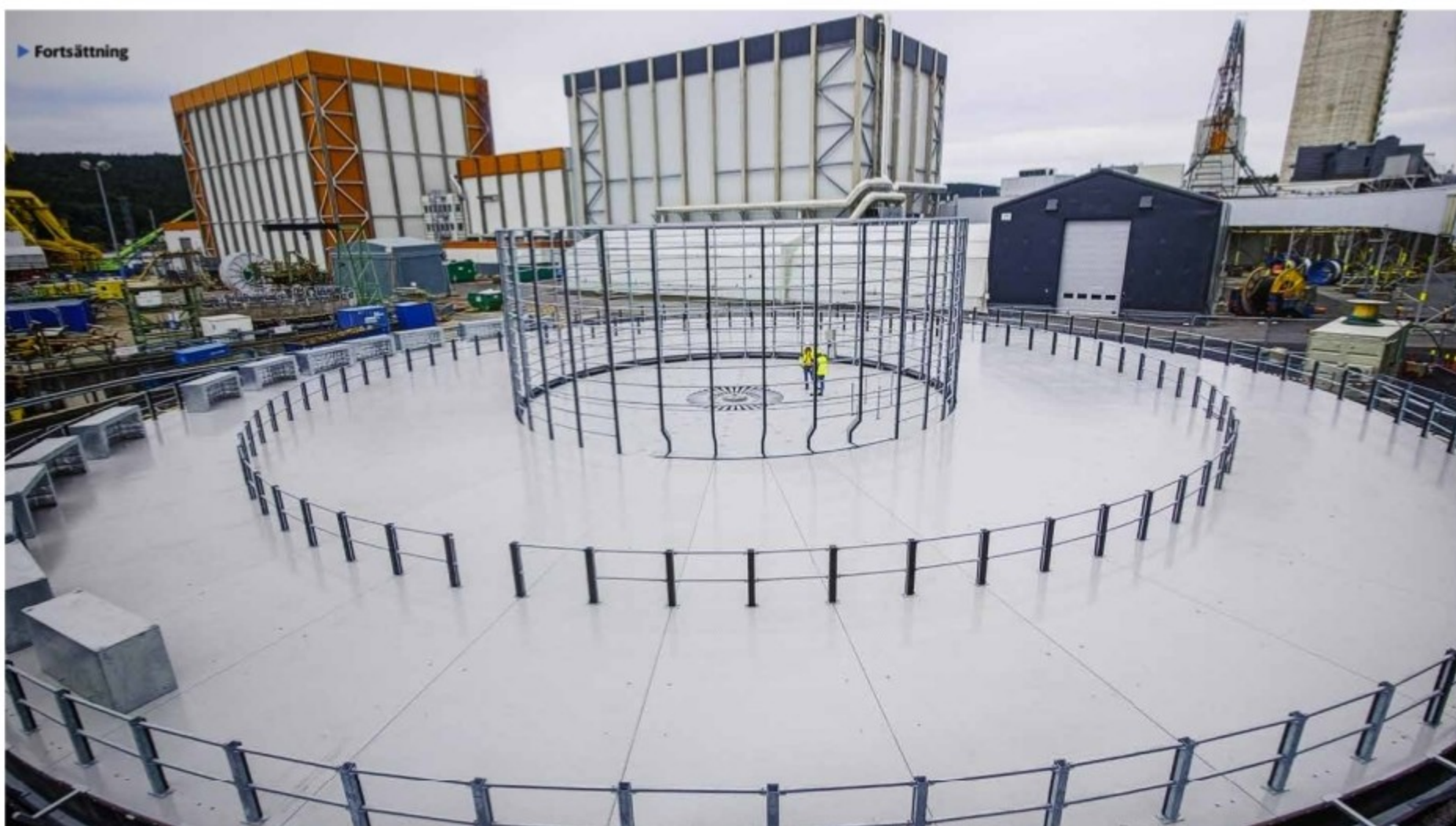
Notera personen i mitten av den stora kabelkarusellen. Uddcomb tillverkar karuseller i olika storlekar, men alla har samma syfte – att förvara dyrbara kablar som sedan ska läggas ut på olika platser i världen. FOTO: MARCUS PALMGREN
